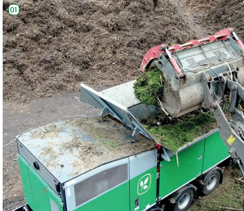
Anche in presenza di voluminosi residui di vegetazione, è possibile un'alta produttività, grazie all'ampio dimensionamento dell'area di alimentazione, alla tramoggia dotata di sponde ribaltabili e ai rotori controrotanti. I blocchi causati dal materiale umido o da un elevato contenuto di erba sono praticamente impossibili. I denti puliscono le griglie di post-triturazione a ogni rotazione.
