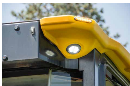
2. Le luci di lavoro ausiliarie includono fari LED posizionati ai lati dei tamburi e agli angoli della cabina per il lavoro in notturna
