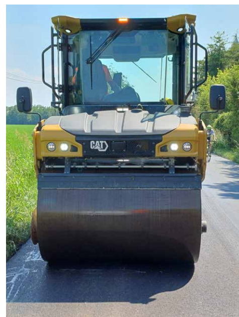
4. Le telecamere frontali e posteriori, montate sui paraurti del rullo, aiutano l'operatore ad individuare in tempo ostacoli durante il movimento
