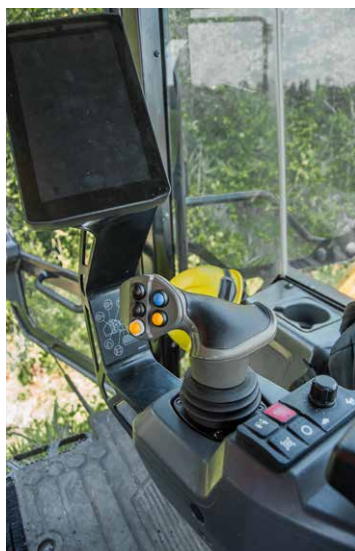
5. Il joystick di traslazione include diversi comandi che permettono di attivare facilmente il sistema vibrante, l'irrorazione dell'acqua e l'offset dei tamburi
