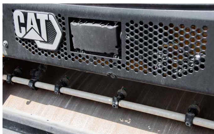
7. Il sistema di irrorazione ottimizza l'erogazione a seconda della direzione di avanzamento del rullo
