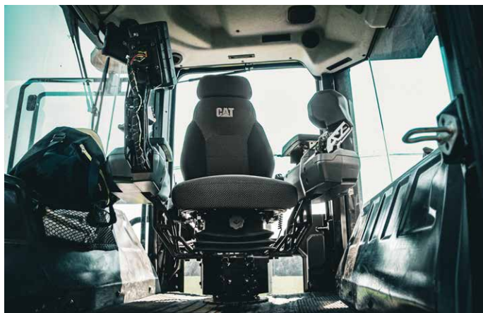
6. I comandi di nuova generazione semplificano l'utilizzo della macchina e includono esclusive funzionalità con l'esclusivo display touch-screen. Il sedile con rotazione a 360 gradi consente di avere una visibilità sempre ottimale del cantiere
