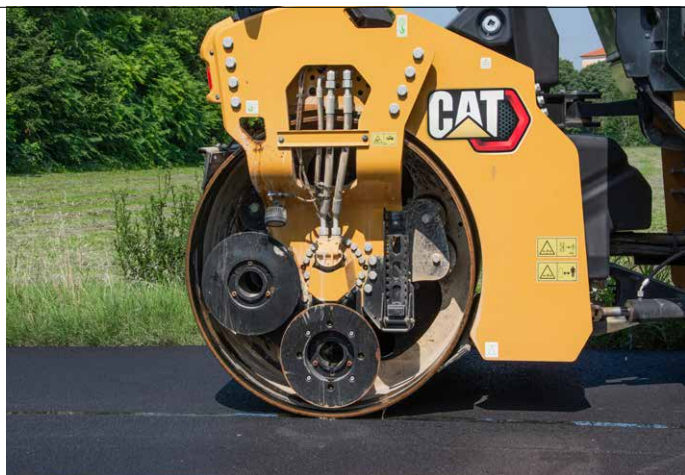
1. I tamburi possono essere disassati fino a 17 cm per uno svolgimento delle passate filo-cordolo
