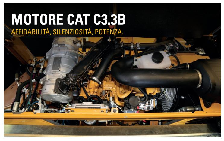
Il motore Cat C3.3B è conforme alla normativa sulle emissioni EU Stage V. Senza spreco di combustibile, la modalità Eco avanzata ottimizza il regime motore ed eroga la potenza secondo necessità, assicurando consumi ridotti e livelli di rumorosità inferiori.
