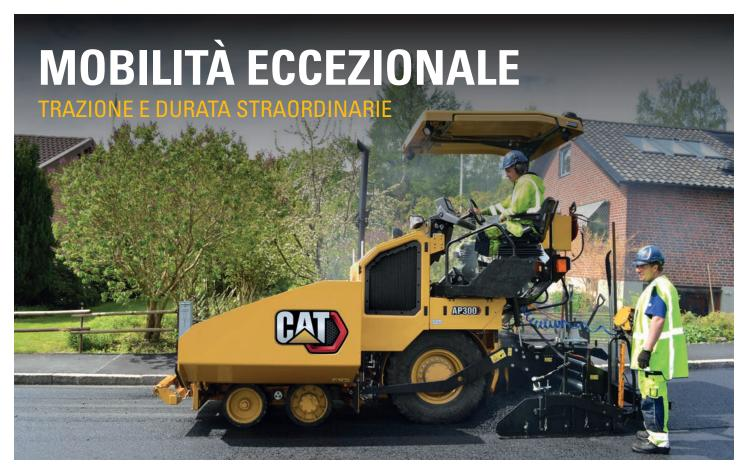
La trazione gommata della AP300 offre un controllo della velocità a reazione rapida, una disponibilità immediata della potenza e velocità elevate negli spostamenti all'interno del sito di lavoro. Il design del carro con cingoli in gomma della AP355 (Mobil-trac) riduce al minimo il movimento del punto di aggancio e garantisce velocità elevate, simili a quelle ottenibili da una vibrofinitrice gommata.
