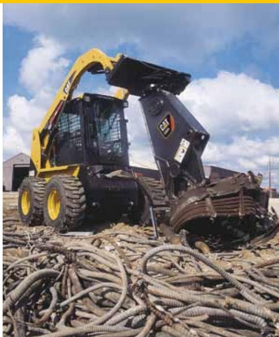
La cesoia mobile per demolizioni e lavorazione di scarti S305, montata su un miniescavatore o una pala Skid Steer, è un attrezzo estremamente produttivo nella lavorazione di acciaio leggero o materiale non ferroso, come per esempio cavi, armature, piccole travi e tubi di piccolo diametro.
